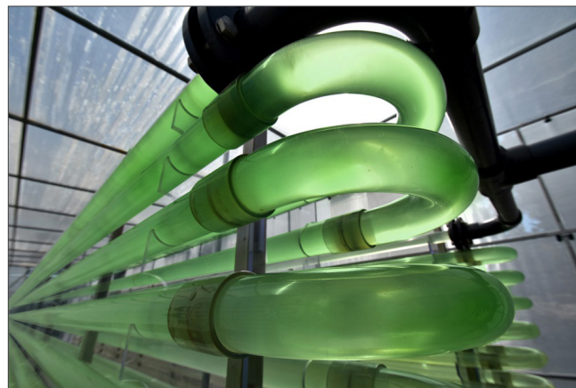
Fig. 15 - Particolare impianto algale a fotobioreattori chiusi
