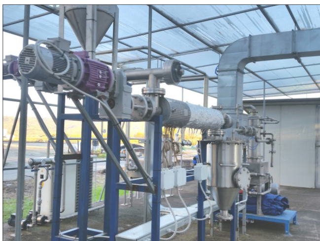
Fig. 7 - Impianto prototipo di pirolisi da 20 kg/h in continuo
