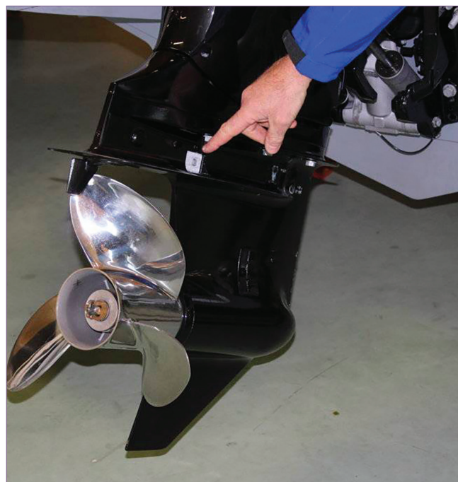
Fig. 1 - Un anodo sacrificale applicato al piede di un fuoribordo Suzuki
