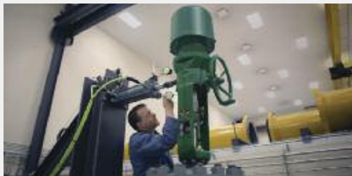
Le valvole di controllo Fisher per applicazioni nucleari testate nel laboratorio sismico dell'Emerson Innovation Centre
